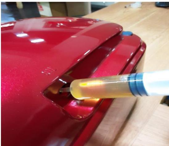
A l'aide d'une seringue + aiguille, introduire 50ml d'huile neuve 10W40.
